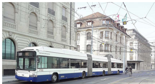
En Ginebra, se ofrecen varias líneas de alta capacidad, comparable con LR, trolebús con 24m de largo, biarticulados y con 4 ejes.
